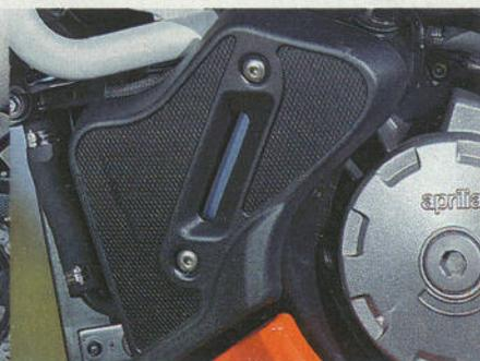
**Leicht gemacht:** Ölstandskontrolle mittels transparentem Röhrchen am Öltank
