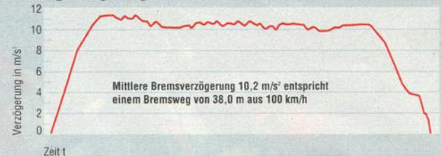
Die Tuono-Stopper arbeiten mit einer mittleren Verzögerung von 10,2 m/s<sup>2</sup> auf allerhöchstem Niveau. Dank ihrer feinen Dosierbarkeit und der hohen Bremsstabilität lässt es sich perfekt an der Blockiergrenze entlanghangeln.
