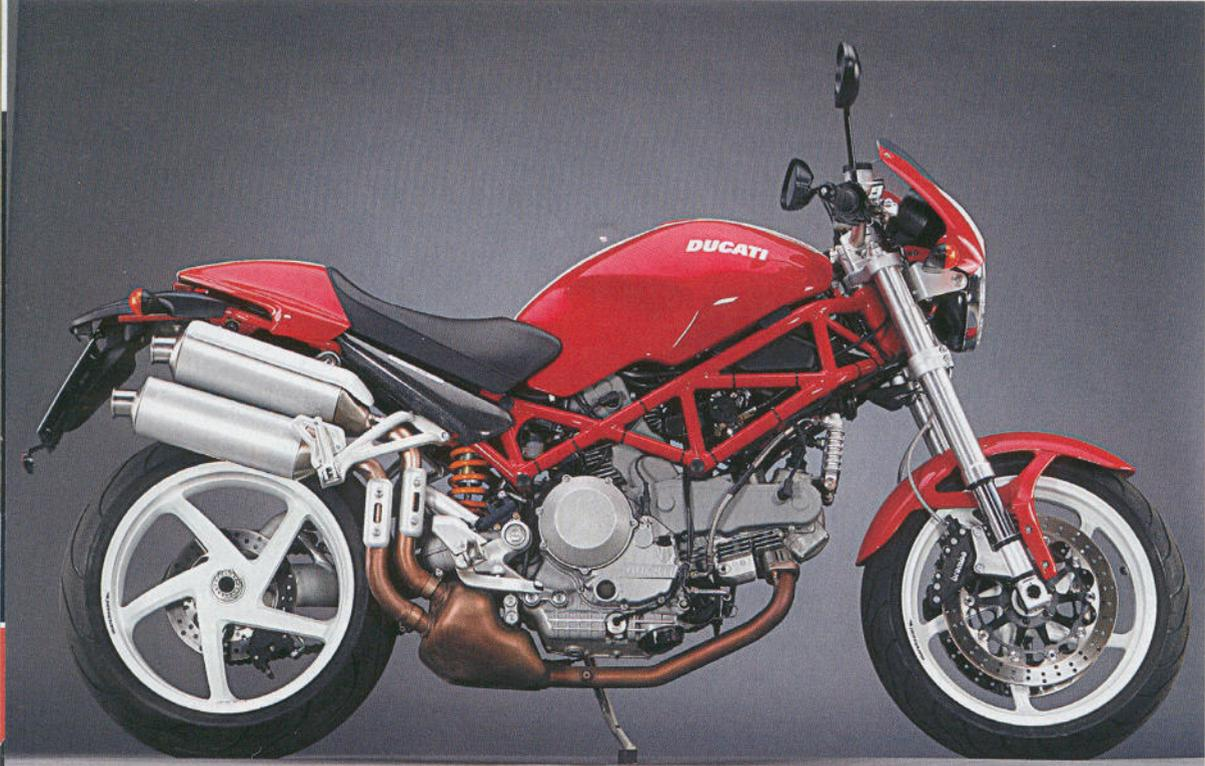
Am Carbon-Deckel mit Schriftzug kann der Laie die S2R 1000 von der 800 Kubik großen S2R unterscheiden.
