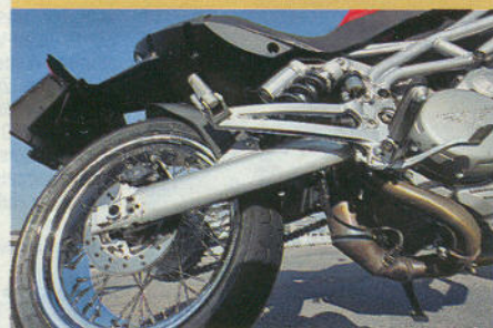
Morini: Die Stahlschwinge, ebenfalls ohne Umlenkung, trägt das Federbein am rechten Holm
