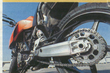
KTM: Die Zweiarms-Alu-Schwinge stützt sich über ein direkt angelenktes PDS-Federbein ab
