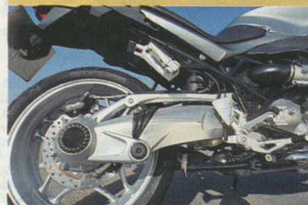
BMW: Die Kardan-Einarmschwinge stützt sich ohne Umlenkung über ein Zentralfederbein ab
