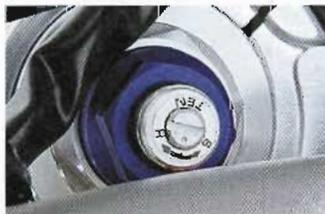
Der linke Gabelholm mit Federvorspanner und Zugstufeneinsteller, ...
