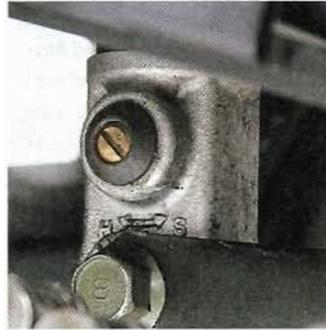
Der Einstellmechanismus für die Zugstufendämpfung und ...
