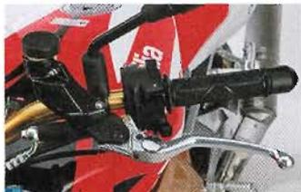
Hydraulikkupplung mit mehrfach einstellbarem Handhebel.
