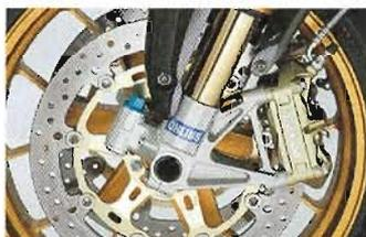
Druckstufeneinsteller mit Gehäuse, Radial-Bremssättel.
