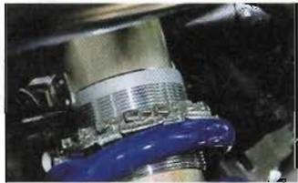
Druckstufeneinsteller mit Ausgleichsbehälter, Federvorspannung mittels Nutmuttern, Einsteller der Zugstufendämpfung unten am Federbein (von oben nach unten).
