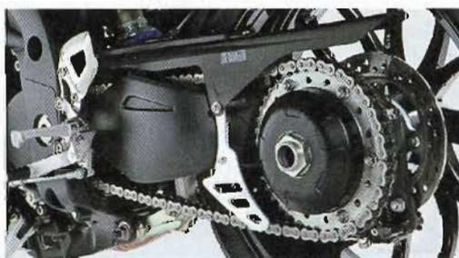
Echter Hingucker: Alu-Einarmschwinge mit Exzenter zur Kettenspannung.
