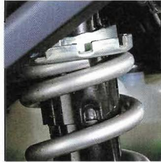
... eine variable Federvorspannung müssen dem FZ1-Heck reichen.
