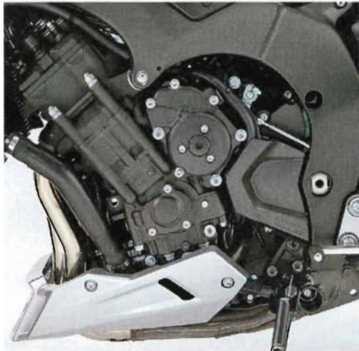
Der FZ1-Treibsatz ist die domestizierte Variante des R1-Four und mit nominell 150 PS der stärkste im Test.
