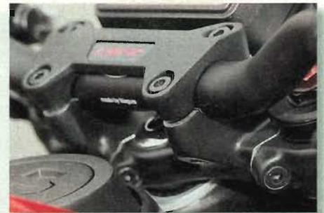
**Tankverschluss im oberen, gewaltigen Rahmenrohr, Lenkerklemmung direkt in der Gabelbrücke**
