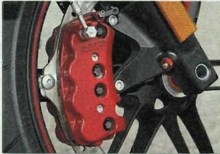
**Buell:** Acht Kolben in einem Schwimmsattel beißen in eine innen an der Felge angeschlagene 375er-Scheibe
